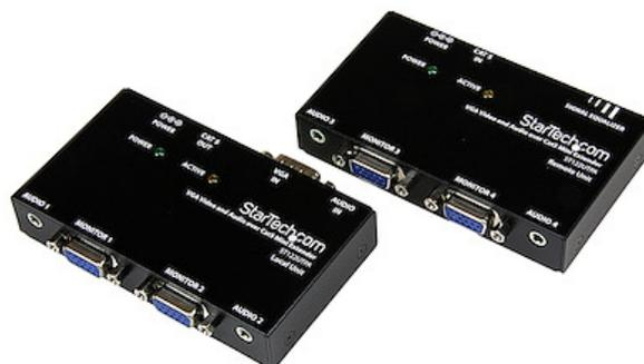
L'extendeur vidéo VGA sur Cat 5 avec audio ST122UTPAEU permet la connexion d'au plus 4 moniteurs (2 locaux et 2 distants) sur un seul PC. Le signal vidéo et l'audio correspondant sont envoyés à une unité distante via un câble 4 paires standard de catégorie 5 ou supérieur (Cat 5e recommandé), prenant en charge des distances vidéo d'au plus 150 mètres.
