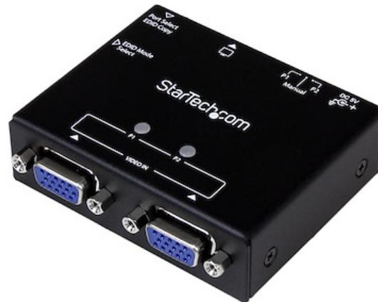
Le commutateur VGA auto ST122VGA à 2 ports permet de partager un écran entre deux ordinateurs et de basculer automatiquement vers le périphérique source actif grâce à la commutation prioritaire configurable. Lorsque le port identifié comme entrée principale est éteint, le périphérique bascule automatiquement sur l'entrée secondaire.
