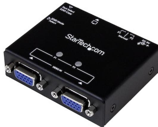
El conmutador automático VGA de dos puertos, modelo ST122VGA, permite compartir una pantalla entre dos computadoras y cambiar automáticamente al dispositivo actual de origen mediante la conmutación de prioridad configurable. Cuando el puerto seleccionado como fuente principal está apagado, el dispositivo cambiará automáticamente a la fuente secundaria.
