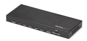
Ce répartiteur HDMI 4K à 4 ports connecte votre source vidéo HDMI à quatre écrans HDMI en même temps, sans déformer ou dégrader votre signal vidéo. Pour des performances fiables, le répartiteur possède un boîtier en métal qui offre un refroidissement passif.
