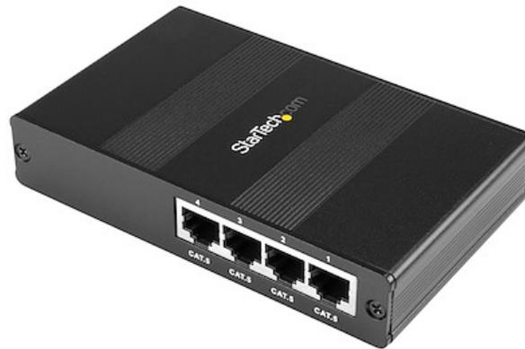
El Extensor de Vídeo VGA de 4 puertos a través de Cat 5 (Serie UTPE), ST124UTPE permite conectar hasta 5 monitores (1 local y 4 remotos) a una única fuente VGA. La señal de vídeo se transmite a los monitores remotos a través un cable UTP de Categoría 5 y Categoría 6 de 4 pares mediante conectores RJ45 y soporta distancias de hasta 300m. En cada monitor remoto se necesita un receptor STUTPRXL (ver accesorios). El receptor convierte la señal del cable UTP en video VGA para el monitor.
