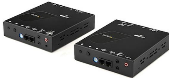
Este kit extensor HDMI a través de IP distribuye video a una ubicación remota, a través de su red de área local (LAN) y cableado Ethernet Cat5 o Cat6. La combinación de este kit con receptores adicionales (se adquieren por separado) y un conmutador Ethernet (se adquiere por separado) puede distribuir la señal de una fuente HDMI a varias ubicaciones y crear muros multivideo mediante varias pantallas y receptores remotos en una misma ubicación.
