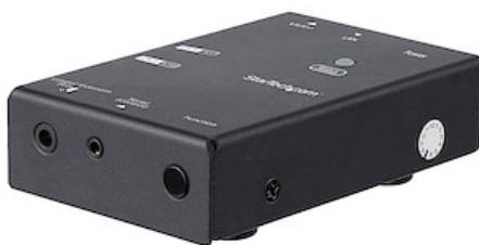
El receptor HDMI® a través de IP funciona con el extensor HDMI a través de IP (ST12MHDLNHK) para distribuir la señal HDMI a una pantalla remota adicional. También puede agregar varios receptores (se adquieren por separado) para distribuir fácilmente su señal HDMI a varias ubicaciones.
