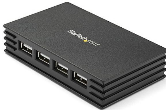
Este concentrador USB 2.0 de 4 puertos permite la conexión de un puerto USB 2.0 en un Mac o un PC, para agregar cuatro puertos USB 2.0: maximiza el número de periféricos USB de alta velocidad conectados a una computadora. El concentrador admite la instalación en cascada con otros concentradores USB 2.0, y soporta hasta 127 conexiones de dispositivos USB 2.0: solución escalable para conectar varios dispositivos USB a un único PC anfitrión.
