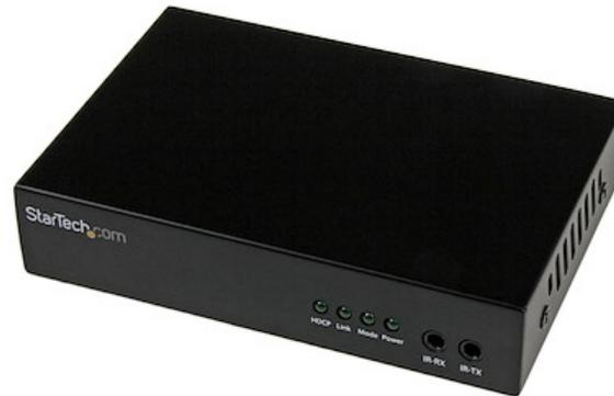
Associé au commutateur de matrice HDMI ST424HDBT, ce récepteur HDBaseT permet de prolonger une source audio/vidéo HDMI jusqu'à 70 m par câble Cat5e/6. Il faut prévoir un récepteur STHDBTRX pour chaque écran à distance.
