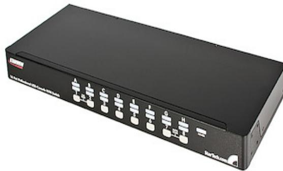
El conmutador KVM USB PS/2 de 16 Puertos con Montaje en Bastidor de 1U y menú en pantalla OSD, SV1631DUSBGB ofrece una herramienta de gestión de ordenadores confiable que permite al usuario controlar hasta 16 ordenadores conectados por USB o PS/2 desde un único teclado, ratón y monitor.
