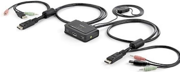
El conmutador KVM de cables DisplayPort®, con 2 puertos y control para la conmutación remota y de audio, modelo SV211DPUA, permite controlar dos computadores equipados con DisplayPort y USB mediante un solo conjunto de periféricos: un monitor, un teclado, un ratón y un solo audio.
