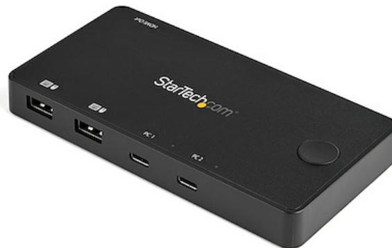
Questo dispositivo KVM USB-C™ a 2 porte consente di passare facilmente tra due computer desktop o laptop USB Type-C o Thunderbolt™ 3 utilizzando una singola tastiera, un mouse e monitor HDMI®.
