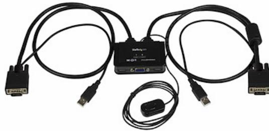
Le commutateur KVM VGA 2 ports avec câbles SV211USB vous permet de contrôler deux PC VGA USB avec un seul jeu de clavier, souris et écran.
