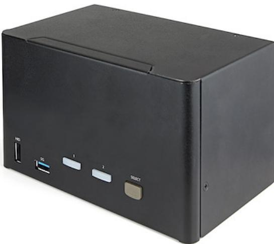
Ce commutateur KVM 2 ports associe des fonctionnalités d'affichage numérique 4K 60 Hz au contrôle d'un maximum de deux ordinateurs connectés.
