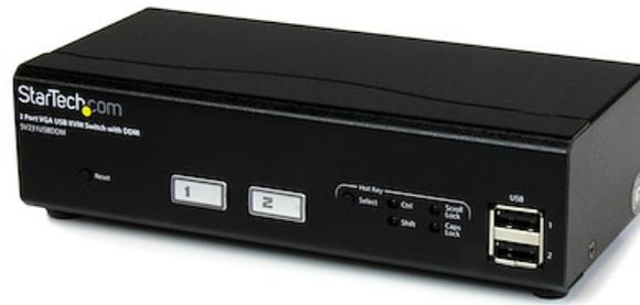
Le commutateur KVM USB VGA à 2 ports SV231USBDDM vous permet de contrôler 2 ordinateurs VGA équipés d'un port USB à l'aide d'un seul jeu de périphériques avec des résolutions VGA haute définition de jusqu'à 1920 x 1440.
