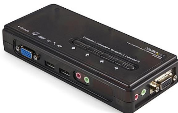
El Kit de Comutador KVM USB de 4 puertos con Audio y Cables, SV411KUSB permite al usuario controlar hasta cuatro ordenadores con USB utilizando un único teclado, ratón y monitor VGA y ofrece una operación mediante teclas de acceso rápido (hotkeys) y botones pulsadores en el panel superior facilitando la conmutación entre los ordenadores conectados.
