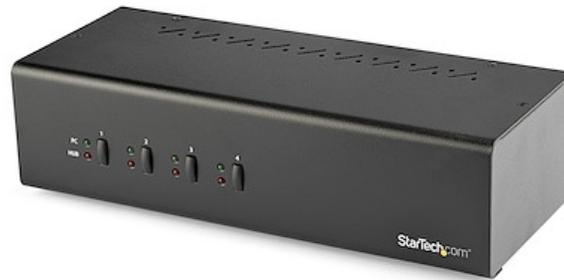
El conmutador KVM para doble pantalla DVI, conforme a las normas TAA, controla cuatro sistemas informáticos multimedia desde una estación de trabajo con doble pantalla DVI.
