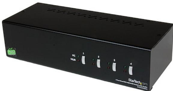
Este conmutador KVM de 4 puertos y doble DVI USB con audio, modelo SV431DVIDDU, permite que cuatro computadoras, cada una con doble salida de pantalla DVI, compartan dos monitores, un micrófono, un juego de altavoces, un teclado y un ratón, así como dos otros periféricos USB.
