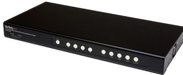
El conmutador KVM con función Quad-View y 4 puertos DVI, modelo SV431DVIUAQV, permite el control de 4 sistemas mediante un conjunto único de periféricos, con conexiones de consola DVI dual y varios modos de pantalla imagen en imagen (PIP)
