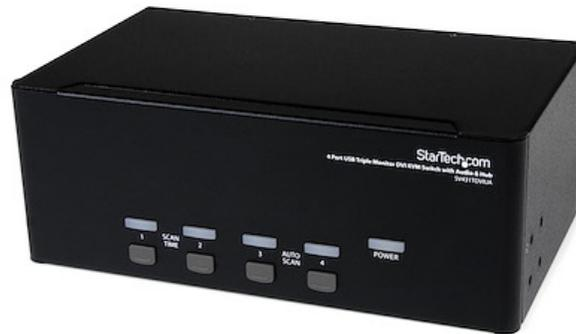
Este conmutador KVM DVI USB triple monitor de cuatro puertos, modelo SV431TDVIUA, permite que hasta cuatro ordenadores (cada uno con tres salidas de vídeo DVI), compartan monitores, un micrófono y juego de altavoces, un teclado y un ratón, así como un periférico USB 2.0 adicional: por ejemplo, un disco duro externo, una unidad de memoria USB, una impresora o una cámara web.
