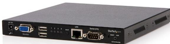
Der 4-Port-USB VGA IP KVM-Switch mit Virtual Media SV441DUSBI ermöglicht sichere lokale Steuerung und Fernsteuerung von bis zu 4 Computern über LAN oder Internet. Mit 2 weiteren USB-Ports für gemeinsame Nutzung von Peripheriegeräten (USB-Speichermedien, CD-ROM usw.), sodass Dateiübertragung und Laufwerkemulation für die Remote-Installation von Anwendungen und Betriebssystemen möglich sind.
