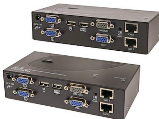
L'extender console KVM doppio VGA USB tramite UTP CAT5 SV565DUTPU consente di utilizzare un PC con doppio VGA o switch KVM fino a una distanza massima di 200 m, come se fosse installato localmente, con una risoluzione ad alta definizione da 1920x1200. I cavi di connessione del PC sono inclusi con il prodotto per una soluzione pronta all'uso.
