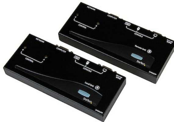
El extensor de consola KVM USB PS2, modelo SV565UTP, permite controlar un servidor, una o varias computadoras (conectadas a través de un conmutador KVM) a través de una conexión por cable de red Cat5 o Cat6 UTP, a distancias de hasta 150 metros.
