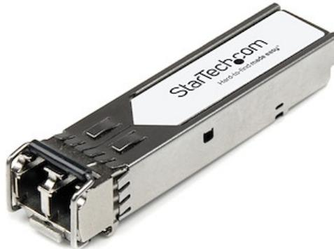
El modelo SX-ST es un módulo transceptor SFP por fibra óptica compatible con el modelo SX de Palo Alto Networks diseñado, programado y probado para su funcionamiento con routers y switches de la marca Palo Alto Networks®. Ofrece conectividad confiable a 1 GbE, a través de cable de fibra óptica, para redes compatibles con 1000Base-SX, a una distancia máxima de hasta 550 m.
