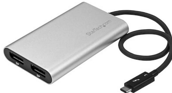
Este adaptador Thunderbolt™ 3 de alto rendimiento le permite agregar dos monitores DisplayPort de 4K 60Hz a una computadora, a través de un único puerto Thunderbolt 3 o se puede utilizar para conectarlo con su puerto Thunderbolt 3 a una pantalla 5K 60Hz mediante dos cables DisplayPort.
