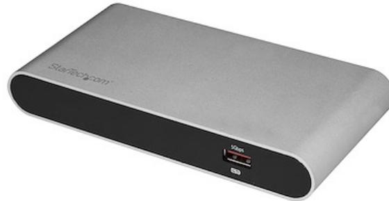
Thunderbolt 3 - USB 3.2 Gen 2マルチチャネルハブコントローラ。Thunderbolt 3対応ノートパソコンに4口の独立した高速USBポートを増設し、高いUSB性能を実現します。外付けUSB機器用として3件の独立USBコントローラと合計20Gbpsの性能を提供し、3Dスキャナなど高い処理能力を必要とするデバイスに最適です。
