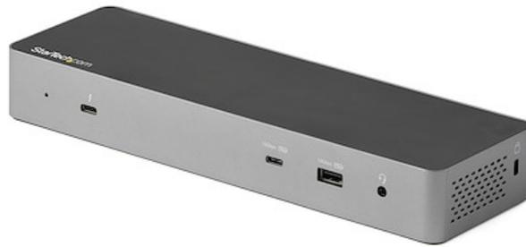
Une station d'accueil Thunderbolt™ 3 certifiée haute performance avec compatibilité USB Type-C offrant une prise en charge de la vidéo DSC 4K 60 Hz à double moniteur via des sorties vidéo Dual ou dual HDMI 2.0, une alimentation de 96 W avec une puissance maximale de 100 W, un concentrateur USB 3.2 avec 5 ports USB et 2 ports de charge rapide BC 1.2, un port Ethernet gigabit et des ports pour casque.
