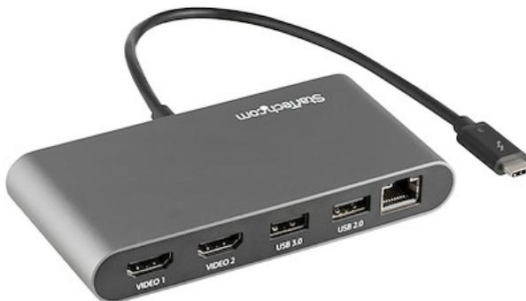
Diese zertifizierte Thunderbolt3 Dockingstation ist ein kompaktes Mini-Dock, das wichtige Verbindungen für eine hohe Produktivität bietet. Das Bus-betriebene Dock verbindet zwei 4K HDMI Displays, Gigabit Ethernet und zwei USB A Anschlüsse. Das angeschlossene Thunderbolt Kabel verfügt über eine zusätzliche Länge von (28 cm) für Flexibilität bei der Einrichtung.
