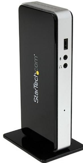
La estación de acoplamiento Thunderbolt™ TBDOCKHDPBC le ofrece un único punto de conexión a su estación de trabajo en casa u oficina, para una configuración flexible con una velocidad formidable. Añadir salidas de vídeo Thunderbolt y HDMI, Gigabit Ethernet, un concentrador USB 3.0 y puertos de audio de 3,5 mm a su portátil equipado con Thunderbolt nunca ha sido tan fácil.
