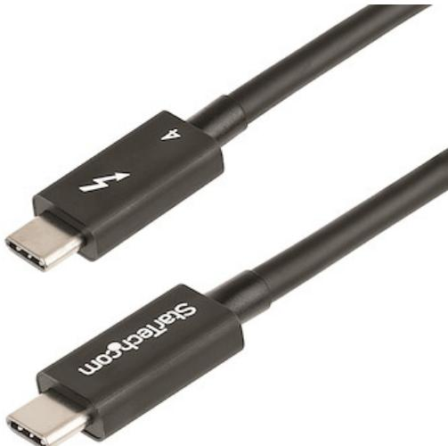
Dieses Thunderbolt™ 4 (40 Gbit/s) Kabel ermöglicht Thunderbolt 4 Signale über USB Typ-C Anschlüsse. Es liefert Video, Daten und bis zu 100 W Power Delivery für Thunderbolt, USB und DisplayPort Geräte.
