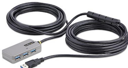
El cable de extensión USB 3.0 de 10m con concentrador USB de 4 puertos y velocidades de transferencia de 5Gbps permite una conectividad multipuerto a distancias que superan las limitaciones estándar de distancia USB 3.0 y de fuente de alimentación. Conecte en cadena hasta dos cables de extensión activos USB para obtener un alcance máximo de 20m.
