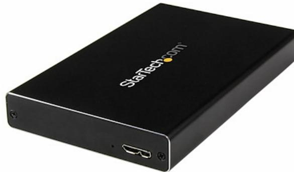
Le boîtier de disque dur 2,5 pouces universel UNI251BMU33 vous permet de transformer un disque dur (HDD) ou un lecteur à état solide (SSD) SATA ou IDE 2,5 pouces en solution de stockage USB 3.0 portable.
