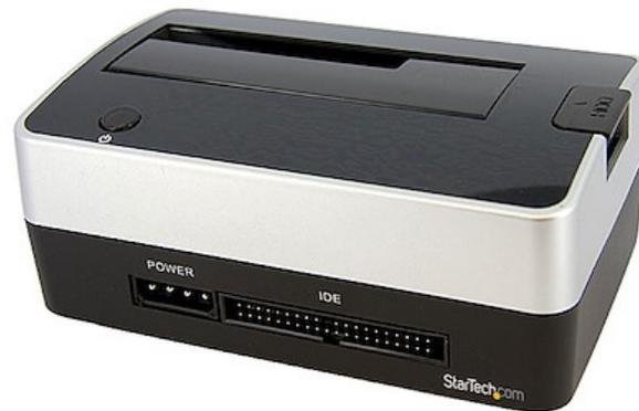
La Estación de Acoplamiento para Disco Duro, UNIDOCK2U ofrece acceso inmediato a cualquier disco duro IDE o SATA de 2,5" y/o 3,5" sin tener que instalar el disco en un ordenador o en un gabinete externo. Se pueden utilizar unidades de gran capacidad (probado con discos de 3,5" de hasta 4TB y de 2,5" de 1TB) para ampliar significativamente las funciones de almacenamiento/copia de seguridad del ordenador.
