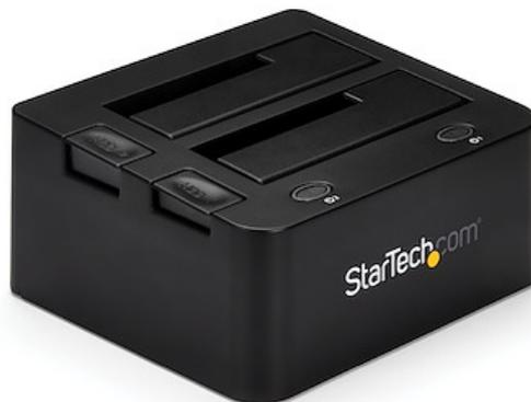
La base universal de acoplamiento USB 3.0 para unidades DD/SSD, modelo UNIDOCKU33, permite el acceso instantáneo a unidades de disco duro IDE y SATA de 2.5" o 3.5", a través de dos ranuras de carga superior, lo cual evita tener que montar las unidades en una computadora o un gabinete externo o charola.
