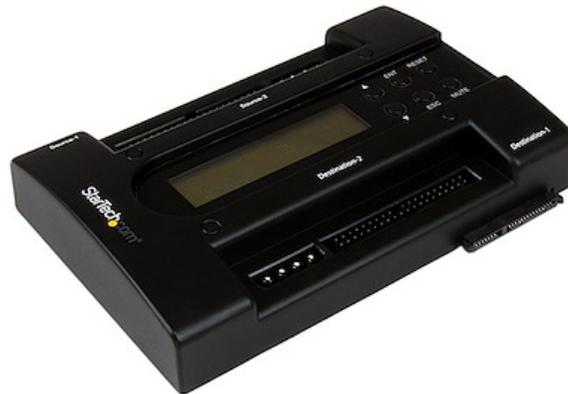
Il duplicatore per doppio disco rigido universale SATA/IDE UNIDUPDOCK funge sia come unità di clonazione/imaging per unità a stato solido (SSD) o dischi rigidi (HDD), ma anche come docking station per SSD o HDD SATA/IDE esterni da 2,5" o 3,5" (SATA, SATA II, SATA III).
