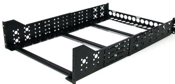
Estos carriles para rack de servidores de 3U le permiten montar equipos que no sean de montaje en rack, como servidores de sobremesa, equipos de red o comutadores KVM, en su rack de servidores de 19" sin sacrificar 1U adicional de espacio de rack, como haría con una estantería tradicional. Los raíles para rack también son una gran solución para montar equipos con carriles dañados o equipos OEM descatalogados como servidores Dell™, IBM®, HP® o Apple que ya no disponen de carriles para rack.
