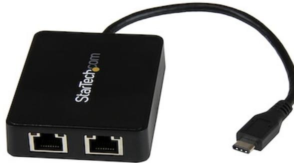
Ahora puede añadir acceso a la red por cable a través del puerto USB-C™ o Thunderbolt™ 3 de su ordenador portátil o de sobremesa, y conectarse a sus dispositivos USB 3.0 (Tipo A) con facilidad.
