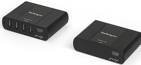
El extensor USB de 2 puertos, modelo USB2002EXT2, permite extender dispositivos USB 2.0 mediante un cable Ethernet Cat 5 o superior a distancias de hasta 100 metros. Un adaptador de alimentación de transmisor local proporciona hasta 500 mA de potencia por puerto, sin que se requiera un adaptador de alimentación en el extremo remoto, lo cual permite el acceso a, así como la alimentación de, cualquier dispositivo USB 2.0 en ubicaciones en las que no esté disponible un tomacorriente.
