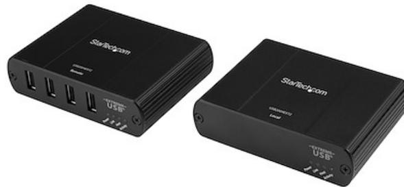
L'extender USB a 4 porte USB2004EXT2 permette di estendere i dispositivi USB 2.0 via Cat 5 o un cavo Ethernet superiore a distanze fino a 100 m. L'adattatore di alimentazione all'estremità remota incluso fornisce fino a 500 mA di alimentazione per porta permettendo l'accesso e l'alimentazione per massimo quattro dispositivi USB 2.0 in punti remoti distanti dal sistema informatico host.
