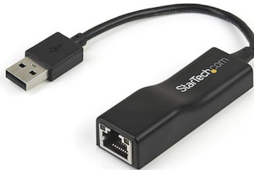
Mit dem USB 2.0-auf-10/100-Mbit/s-Netzwerkadapter USB2100 können Sie einem Laptop oder Desktopcomputer über USB einen Fast Ethernet-Anschluss hinzufügen.
