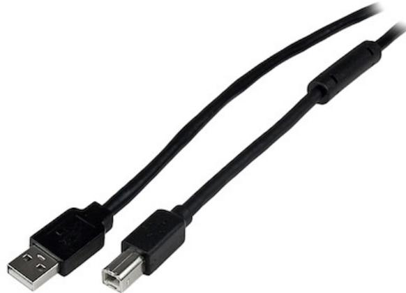
El cable USB A a B, de 20 metros , modelo USB2HAB65AC, incorpora circuitos activos con alimentación mediante bus, lo cual permite transmisiones más allá del límite de 5 metros de los cables USB estándar.
