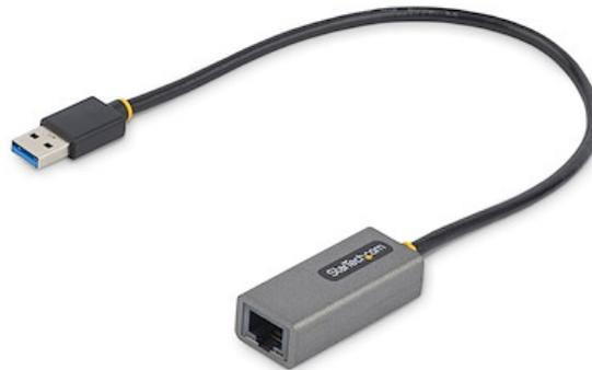
Añada fácilmente un puerto de red Gigabit a su ordenador a través de un puerto USB 3.0/3.2 Gen 1 Tipo-A. El puerto RJ45 admite múltiples velocidades (10/100/1000 Mbps) y es totalmente compatible con el cableado Cat5, Cat5e, Cat6 y Cat6a. Se trata de un periférico ideal para los portátiles más recientes que ya no tienen puerto Ethernet. Gracias a la retrocompatibilidad, puede añadir capacidades de red a los ordenadores más antiguos o sustituir un puerto Ethernet que no funcione.
