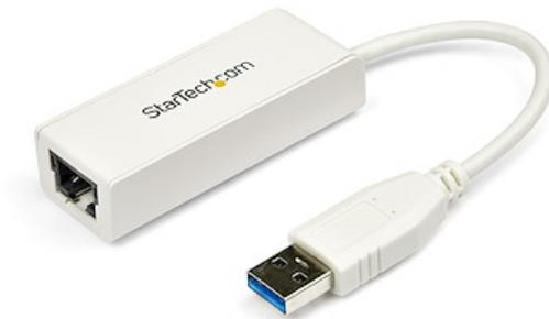
La tarjeta adaptadora de USB 3.0 a Ethernet Gigabit, modelo USB31000SW, permite agregar un único puerto Ethernet RJ45 a un sistema informático con USB disponible, con soporte para conexiones de red Gigabit a pleno ancho de banda cuando se utiliza con una conexión host USB 3.0, a diferencia de adaptadoras USB 2.0.
