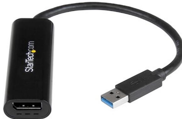
L'adattatore slim USB 3.0 a DisplayPort trasforma una porta USB 3.0 in un'uscita DP. L'adattatore riduce al minimo l'ingombro grazie al design sottile salva-spazio, che si adatta perfettamente al cavo video utilizzato: una soluzione perfetta per applicazioni multimonitor su computer Ultrabook™, laptop o desktop.
