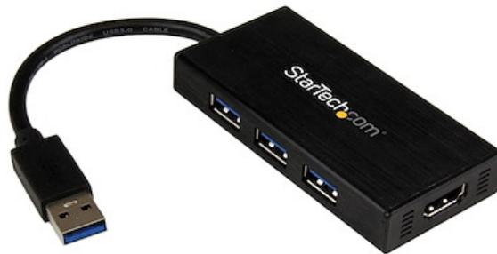
L'adaptateur USB 3.0 vers HDMI USB32HDEH3 transforme un port USB 3.0 en port de sortie HDMI avec prise en charge vidéo 1920 x 1200/1080p. Cet adaptateur est doté d'un hub USB 3.0 à 3 ports intégré, ce qui vous permet de brancher trois appareils USB différents, en plus de la carte graphique, au même port USB 3.0. Une solution parfaite pour les ordinateurs Ultrabook ou portables qui ne comportent qu'un nombre limité de ports USB.
