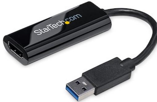
El adaptador compacto USB 3.0 a HDMI, modelo USB32HDES, convierte un puerto USB 3.0 en un puerto de salida HDMI con soporte para video de 1920x1200/1080p. El adaptador minimiza los enredos de cables gracias a su diseño, que se mimetiza sin problemas con su cable de video: es una solución ideal que ahorra espacio en aplicaciones con varios monitores para su uso con computadores Ultrabook™, portátiles o de escritorio.
