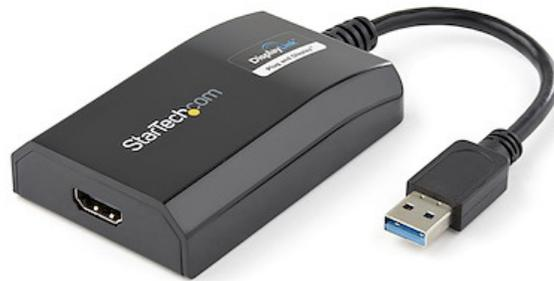
L'adattatore USB32HDPRO USB 3.0 a HDMI consente di aggiungere un display HDMI al computer mediante una porta USB 3.0, offrendo l'opportunità di espandere in maniera economica e conveniente le capacità video del sistema di computer Mac® o PC.
