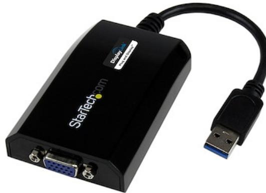
El adaptador USB 3.0 a VGA, modelo USB32VGAPRO, convierte un puerto USB 3.0 disponible de un computador de escritorio o portátil en una salida VGA, con soporte para alta resolución 1920x1200/1080p: una práctica solución externa para vídeo que facilita agregar capacidad multimonitor a un computador Mac® o PC equipado con USB 3.0 (rendimiento óptimo con USB 3.0, retrocompatible con USB 2.0).
