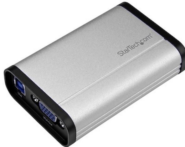
Questo dispositivo di acquisizione video da VGA a USB consente di registrare video VGA ad alta definizione sul computer. Con un box esterno in alluminio, questo dispositivo ha una solida struttura per l'acquisizione di video sia in posizione fissa che in movimento. Offre un ingresso audio distinto da 3,5 mm per l'audio di accompagnamento o il voice-over, e una porta VGA pass-through per il collegamento a un monitor per vedere il video mentre viene acquisito.
