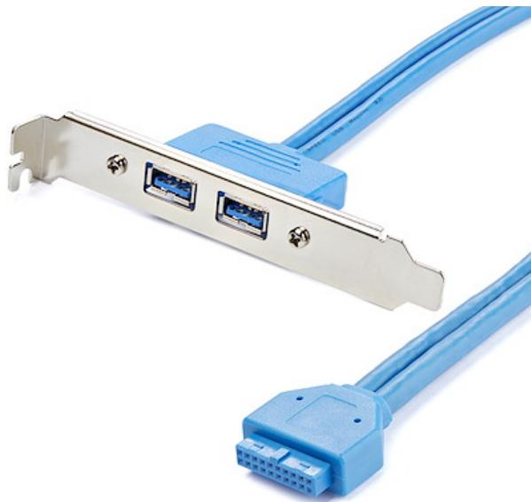
2ポートUSB 3.2 Gen 1 Aスロットプレート。USB 3.2 Gen 1マザーボードヘッダのUSBピンを2口の標準USB 3.2 Gen 1 Aタイプポートに変換します。コンピュータ筐体のリアパネルに装着し、USB 3.2 Gen 1 Aメスポート2口を増設してUSB周辺機器が簡単に接続できるようになります。
